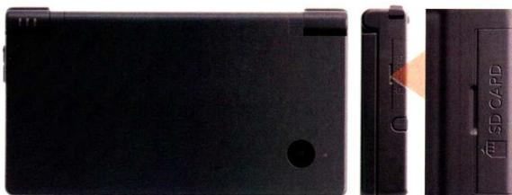
Die kleine Linse der Front-Kamera sticht sofort ins Auge. Weniger auffällig ist der neue Slot für SD-Karten an der rechten Seite. Dafür muss der DSi ohne GBA-Modulschacht auskommen.
