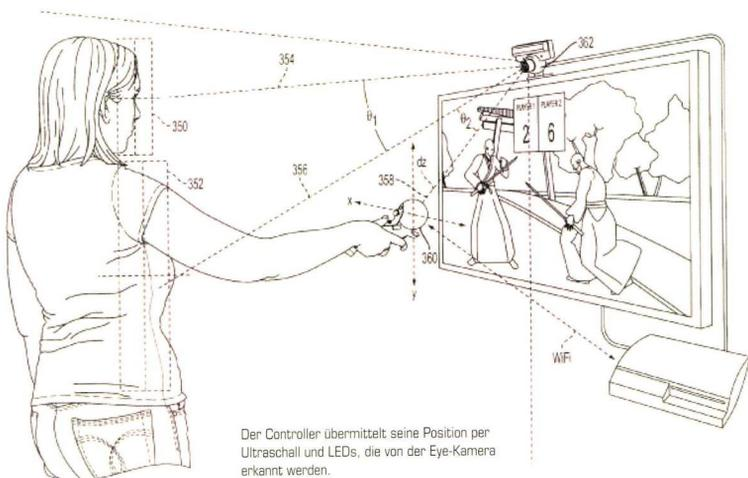
Der Controller übermittelt seine Position per Ultraschall und LEDs, die von der Eye-Kamera erkannt werden.
