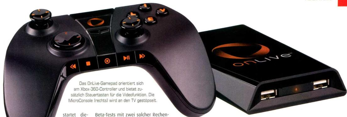
Das OnLive-Gamepad orientiert sich am Xbox-360-Controller und bietet zusätzlich Steuertasten für die Videofunktion. Die MicroConsole (rechts) wird an den TV gestöpselt.
