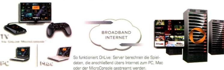
So funktioniert OnLive: Server berechnen die Spieldaten, die anschließend übers Internet zum PC, Mac oder der MicroConsole gestreamt werden.
