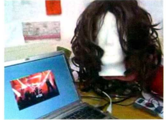
Sensoren in der Perücke registrieren Beschleunigungskräfte, die Software verarbeitet sie in Echtzeit.
