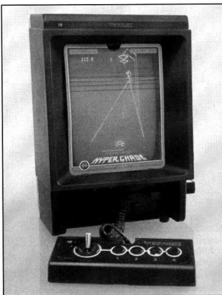
Abb. 160: Das Vectrex-System ar- beitete vek- tororientiert.
