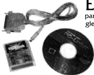
Abb. 10: »Backup Unit« für den Game- boy mit Software und Verbin- dungskabel zum PC
