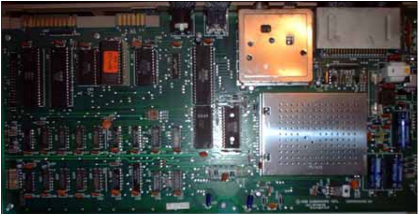
Abb. 6: Die sog. KU- Platine zählt ebenfalls noch zu den C64-Urplatinen
