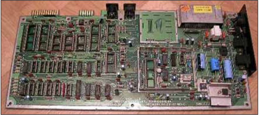
Abb. 23: gesäuberte Platine mit Präzisions- fassungen
